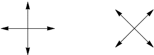
La base HV (à gauche) et la base diagonale (à droite) pour la polarisation
